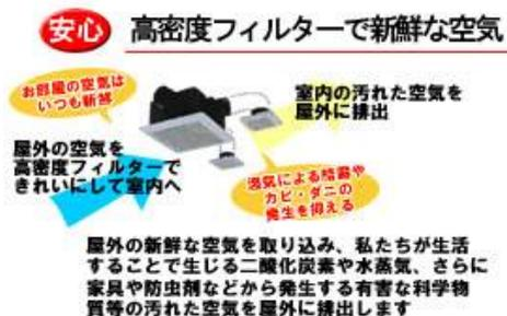
第3種換気設備(各室より新鮮外気を取り入れ、台所・脱衣室・トイレより排気する方式)を標準とします。
